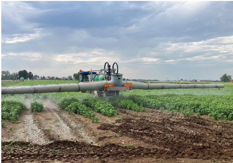
Figura 16 - Irroratrice con ozonizzatore in funzione
